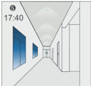
При недостаточном естественном освещении светильник автоматически включается на 10% (даже при отсутствии движения).
