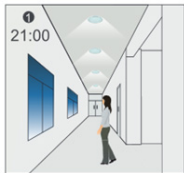
При обнаружении движения освещение включается на 100%.
