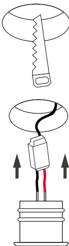
Рис. 2. Установка и подключение светильника
